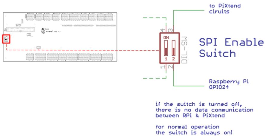
Figure 55: Simplified wiring diagram: SPI enable
